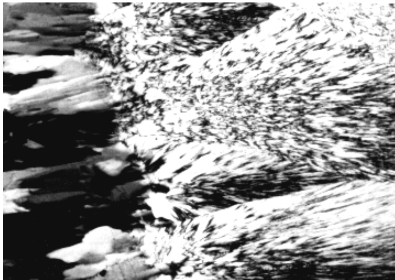
Fig. 9. Nodul de silice concreționară (fragment din aluviuni, Valea Cordurea, Hărtăgani). Zona marginală se compune din cuarț microgranular – alungit, și cuarț microfibrilos dispus în evantai. Microfotografie, N +, 35 X
